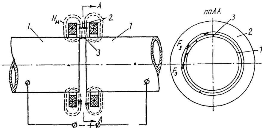
Рис.1. Схема сварки вращающейся магнитоуправляемой дугой:
