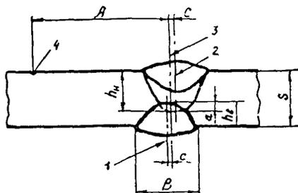
Рис.1. макрошлиф образца из допусчного стыка:
