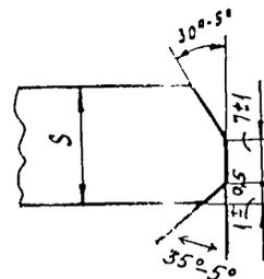
Для труб диаметром 720-1420 мм
