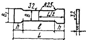
5.2.3. Форма образцов для испытаний на изгиб при толщине стенки трубы до 12,5 мм включительно должна соответствовать типу ХХУП ГОСТ 6996-66. При испытании образцов на ребро его сечение должно быть равно 12,5 мм x  $\delta$  стенки трубы (рис.2).
