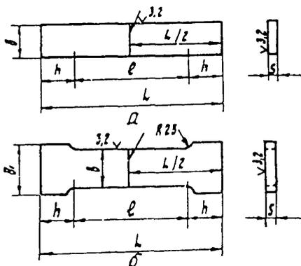
Рис. 3. Эскизы плоских образцов для испытания на статическое растяжение по ГОСТ 6996-66:
