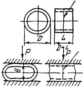
Рис.6. Эскиз трубчатого образца типа ХХХ для испытания на сплющивание по ГОСТ 6996-66:
