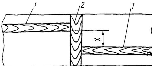
Рис.15. Схема сварки труб с продольным швом:
