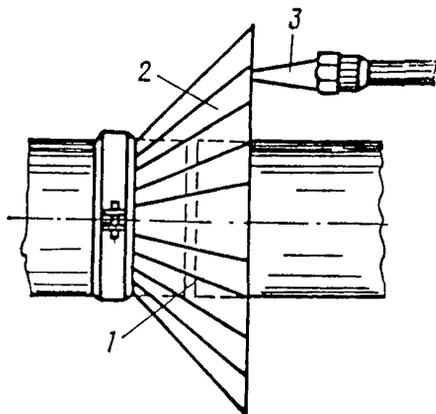
2.11.67. При установке нагревателей на сварном стыке необходимо тщательно изолировать места возможного отвода тепла:
