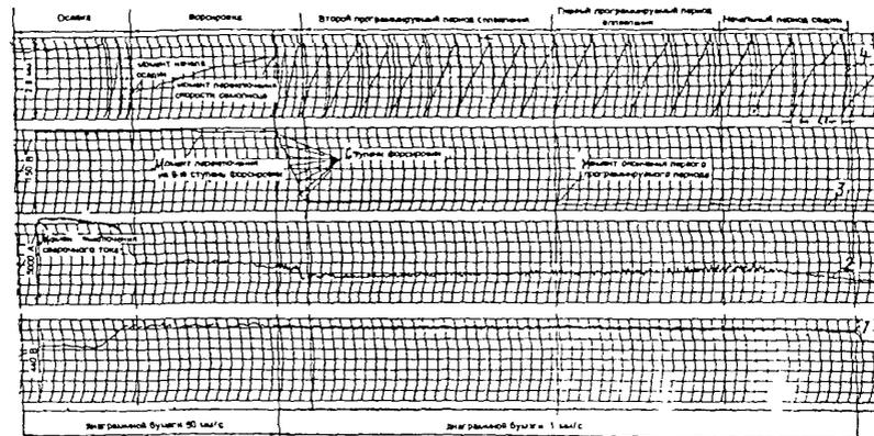
Рис.1. Диаграмма записи параметров сварки
