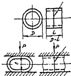
Рис.4. Эскиз трубчатого образца типа ХХХ для испытания на сплющивание по ГОСТ 6996-66:
