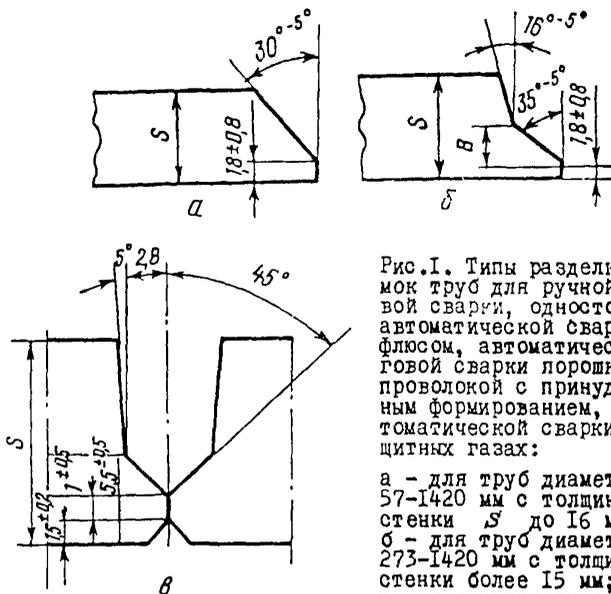
Рис. I. Типы разделки кромок труб для ручной дуговой сварки, односторонней автоматической сварки под флюсом, автоматической дуговой сварки порошковой проволокой с принудительным формированием, полуавтоматической сварки в защитных газах:
