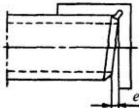
Рис. 6.1. Схема проверки перпендикулярности торцов труб
