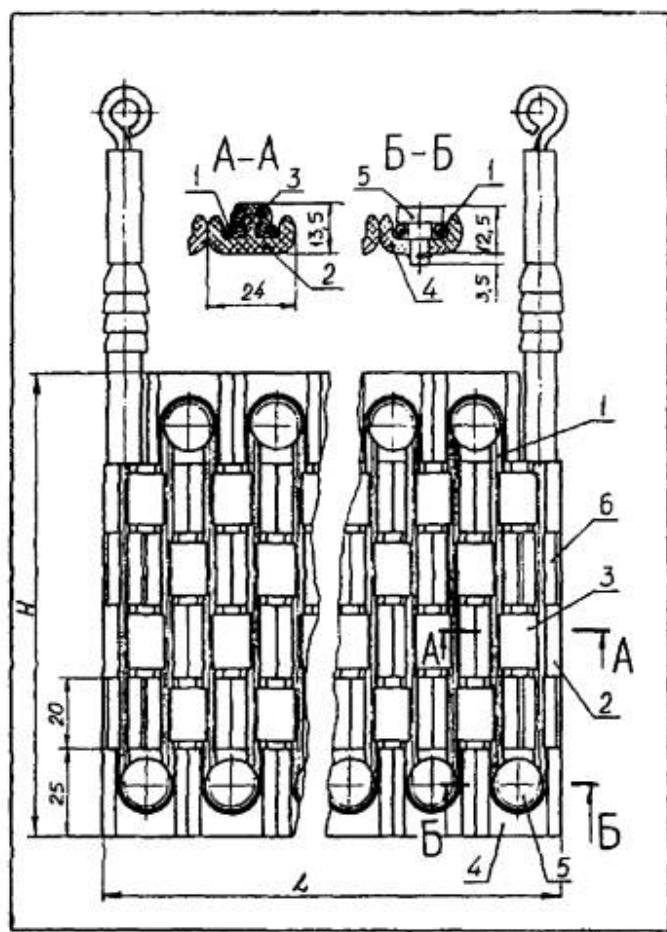
Рис. 17.5. Гибкий радиационный электронагреватель ГРЭН:
