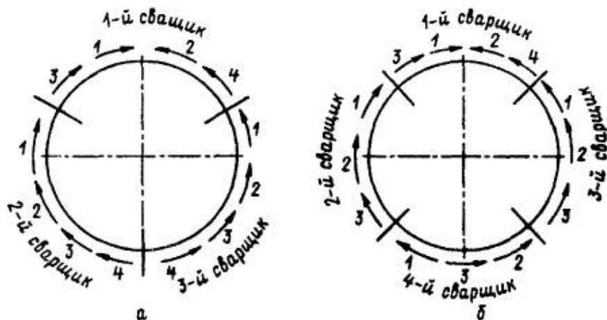
Рис. 7.7. Порядок сварки трёхмя (а) и четырьмя (б) сварщиками вертикального неповоротного стыка труб диаметром более 600 мм:
