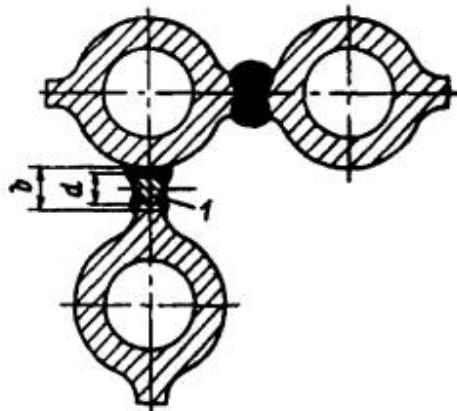
Рис. 16.4. Соединение стенок газоплотных панелей:
