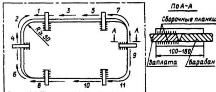
Рис. 20.4. Установка заплаты на сборочных планках
