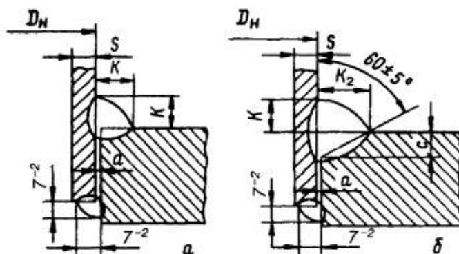
Рис. 7.18. Приварка плоских фланцев к трубе:
