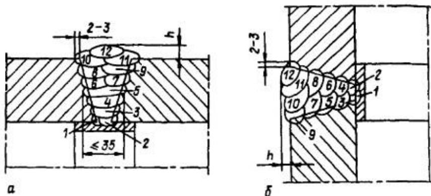
Рис. 11.3. Примерное расположение слоев и валиков по сечению шва вертикального неповоротного (а) и горизонтального (б) стыков труб с разделкой Тр-3в (угол скоса 15°), выполненных механизированной сваркой в среде углекислого газа:
