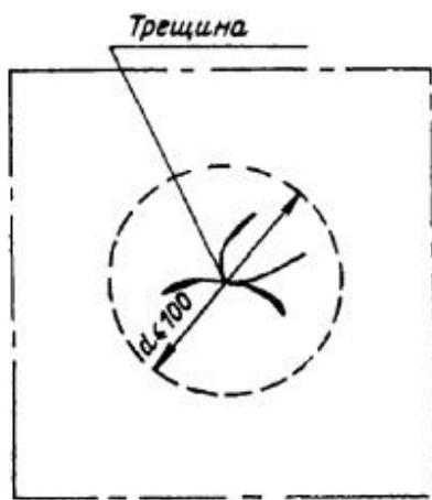
Рис. 20.3. Исправление скопления трещин путем сварки заглушки
