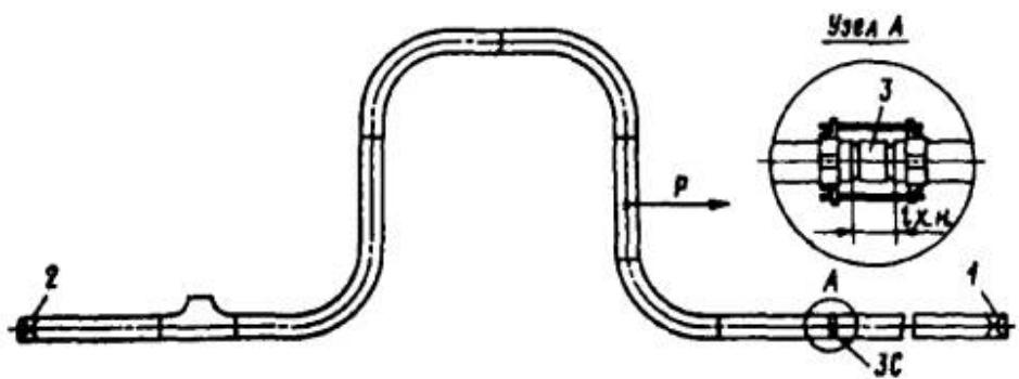
Рис. 6.7. Схема сборки и сварки замыкающего стыка при холодном натяжении:
