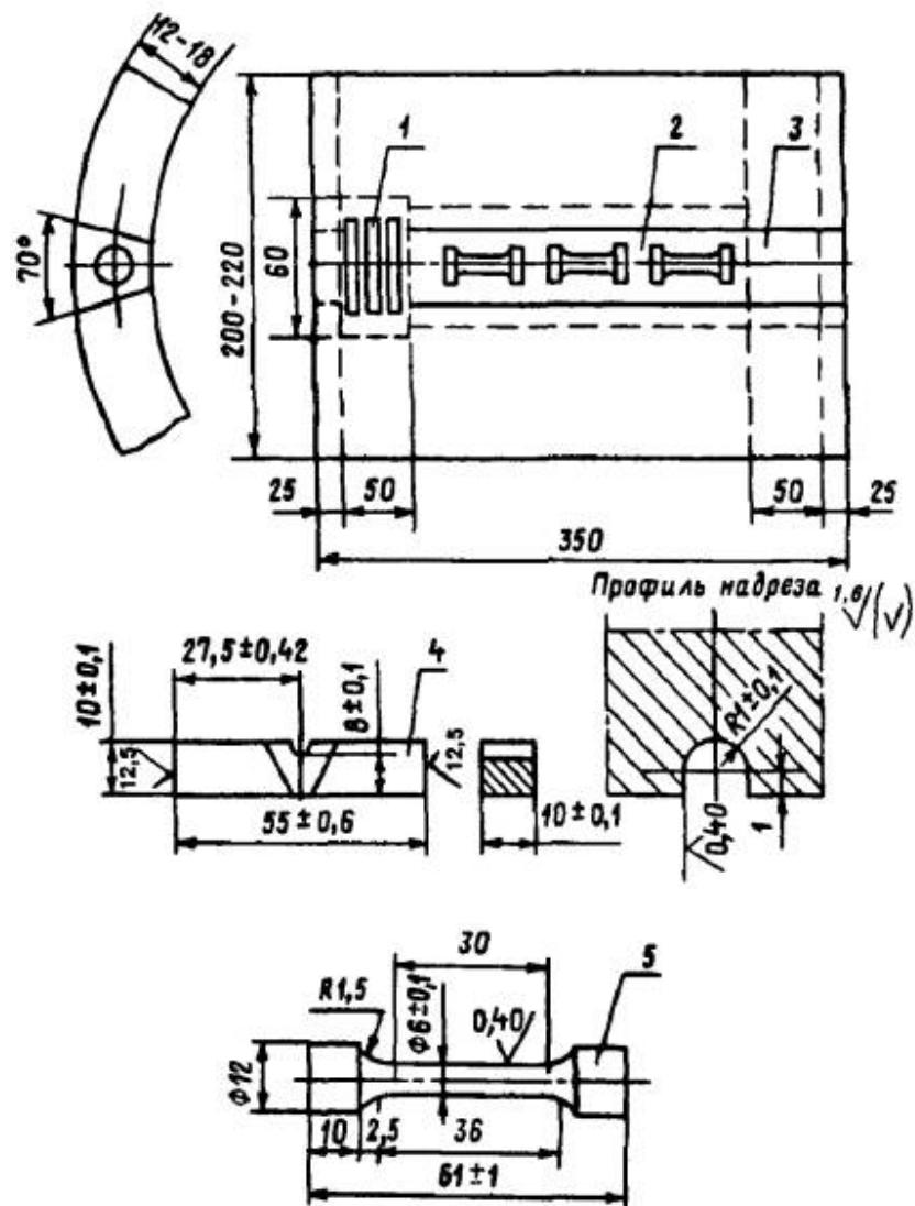
Рис. 5.2. Схема вырезки образцов для испытания металла шва:
