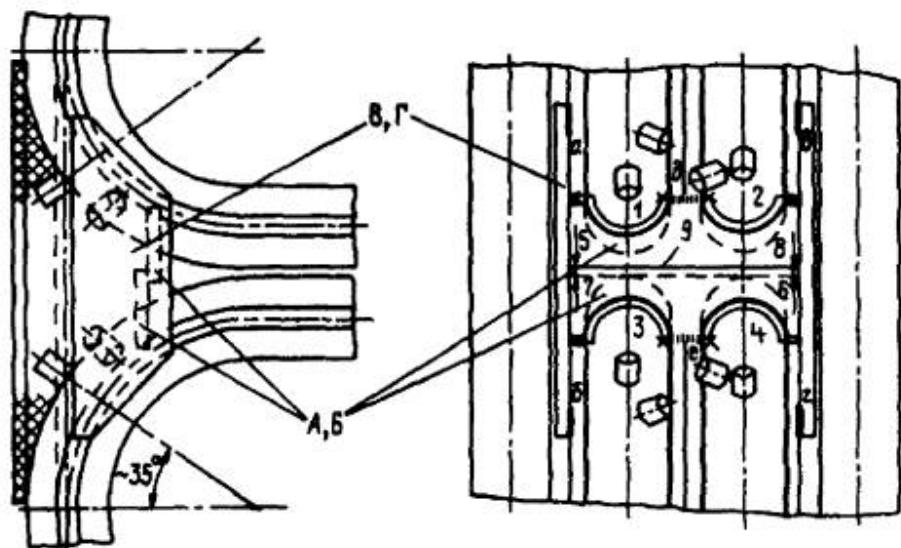
Рис. 16.7. Последовательность сварки (1 - 9) узла уплотнения разъемов топочных экранов
