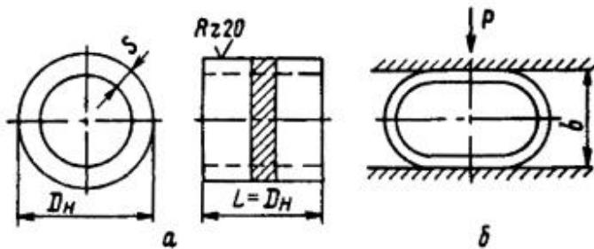
Рис. 18.6. Испытание на сплющивание:
