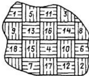
Рис. 20.1. Заплавка раковины
