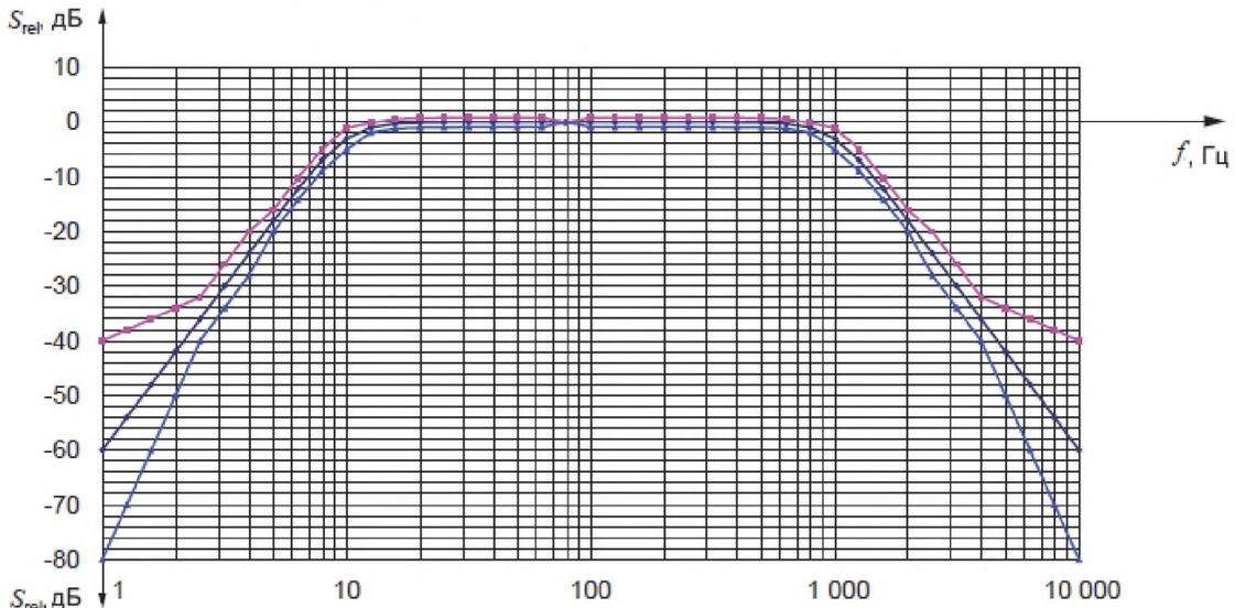
$S_{\text{rel}}$  – Относительный коэффициент преобразования;  $f$  – частота
