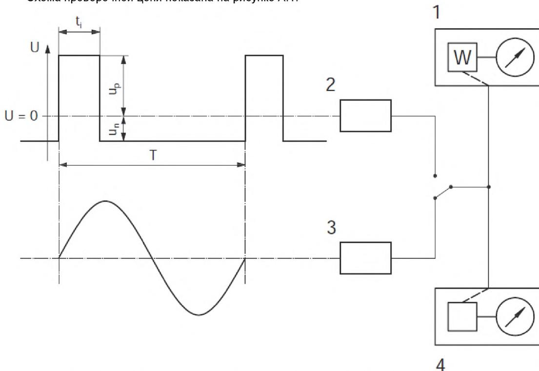
1 – измеритель истинного среднеквадратичного значения; 2 – генератор прямоугольных импульсов; 3 – генератор гармонических колебаний; 4 – испытуемый блок; W – цепь обработки сигнала;  $T$  – период повторения сигнала;  $t_i$  – длительность положительного прямоугольного импульса;  $U$  – напряжение тестового сигнала (как функции времени);  $u_n$  – напряжение отрицательного прямоугольного импульса;  $u_p$  – напряжение положительного прямоугольного импульса
